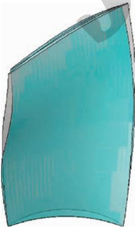
图 23 第 2 级转子修改前后的三维示意图 Fig. 23 Three-dimensional schematic diagram of 2nd stage blade
